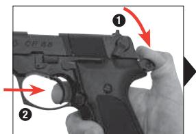
Поставить оружие на предохранитель.
